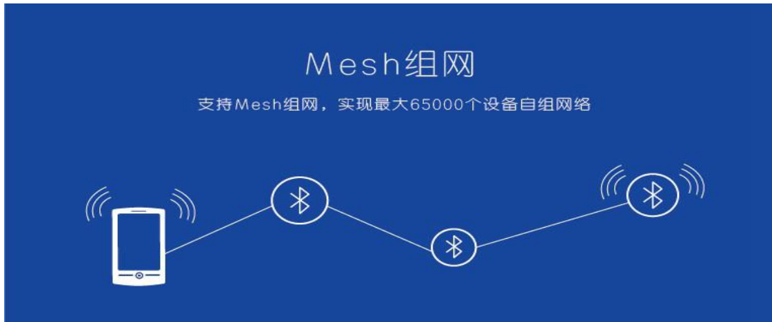
图 19. Mesh 组网示意图
