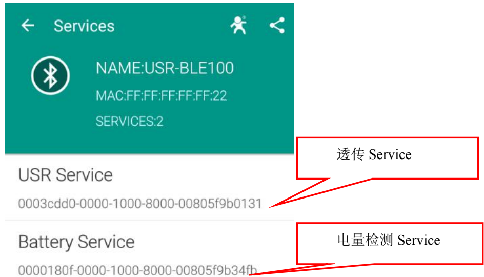
图 6. 模块 Service 示意图
